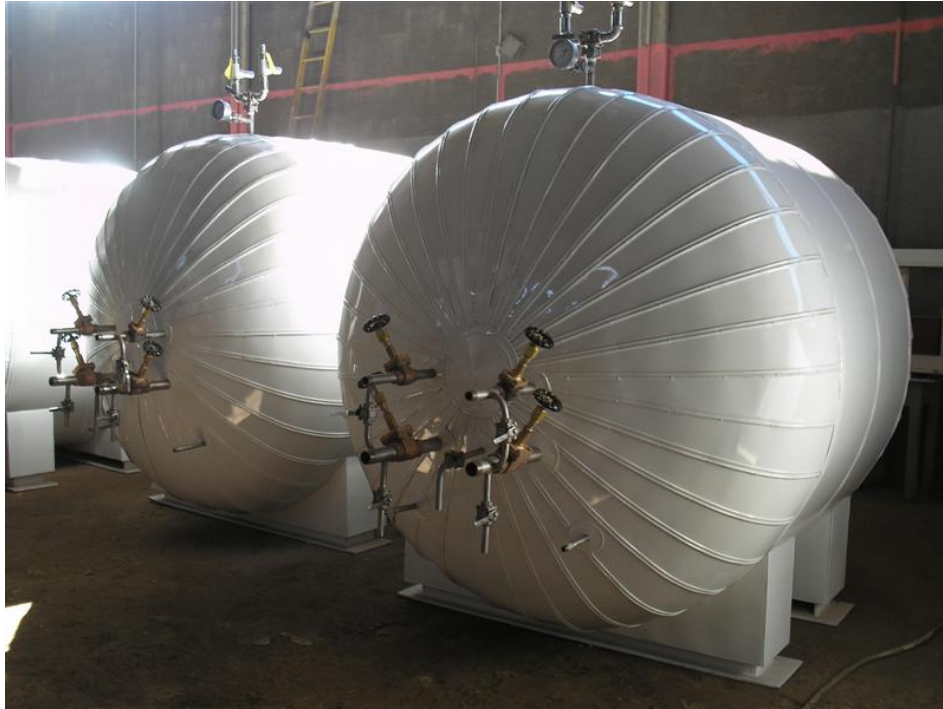
Ejemplo de tapa ejecutado en gajos.
